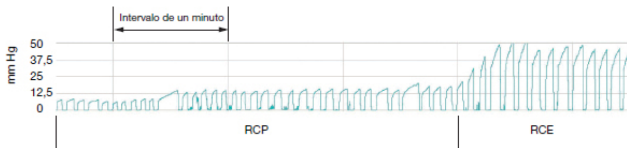
Figura 37. Capnografía durante la RCP con RCE. Este registro capnográfico muestra la PETCO 2 en milímetros de mercurio en el eje vertical respecto al tiempo. Este paciente está intubado y recibe RCP. Tenga en cuenta que la frecuencia de ventilación es de aproximadamente 10 ventilaciones por minuto. Se están aplicando compresiones continuamente con una frecuencia ligeramente superior a 100 por minuto, pero en este registro no se aprecian. La PETCO 2 inicial es menor de 12,5 mm Hg durante el primer minuto, lo que indica un flujo sanguíneo muy bajo. La PETCO 2 aumenta hasta 12,5 y 25 mm Hg durante el segundo y tercer minuto, compatible con el aumento en el flujo sanguíneo con reanimación continua. El RCE se produce en el cuarto minuto. El RCE se reconoce por un abrupto aumento de la PETCO 2 (visible justo después de la cuarta línea vertical) hasta superar los 50 mm Hg, coherente con una mejora sustancial del flujo sanguíneo.
